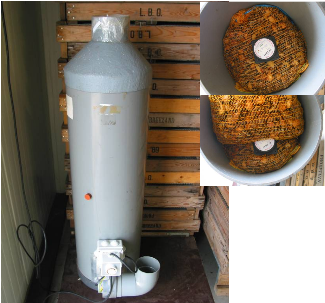
Partij 1 tulp cv Yokohama plantgoed onbehandeld in modelpalletkist. Model-palletkist, kolom bollen van 70 cm Ø, bollen in netzakjes. Mijtenval bovenin kolom en onder één netzakje tulpenbollen.
