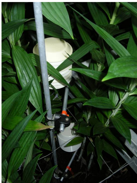
Foto 2. Links sensor 1 en 2 (onderin en halverwege het gewas), rechts sensor 3 en 4 (knophoogte en boven het gewas).
