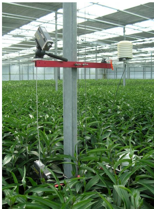
Foto 2. Links sensor 1 en 2 (onderin en halverwege het gewas), rechts sensor 3 en 4 (knophoogte en boven het gewas).
