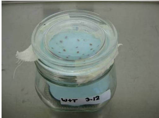
Foto 2.7. Glazen pot met onderin filtreerpapier met extract en bovenin kiemende tuinkerszaden gelegen op kaasdoek en filtreerpapier.
