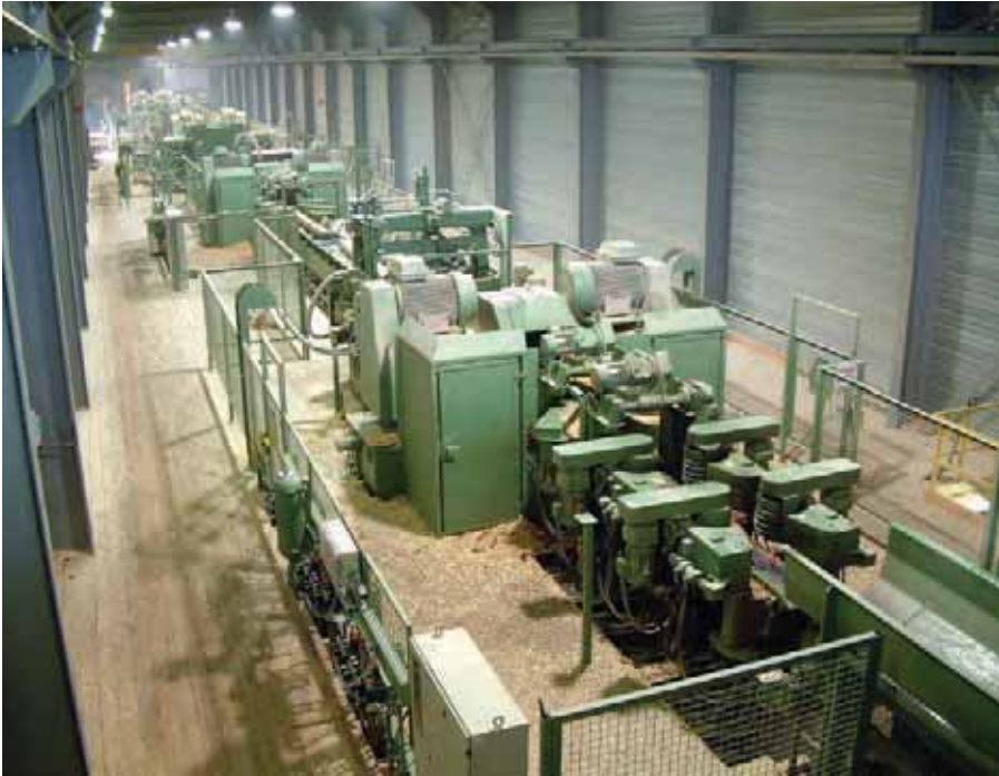
Profielverspaner bij Willemsen Naaldhout kan tot maximaal 50 cm aan de voet verzagen
