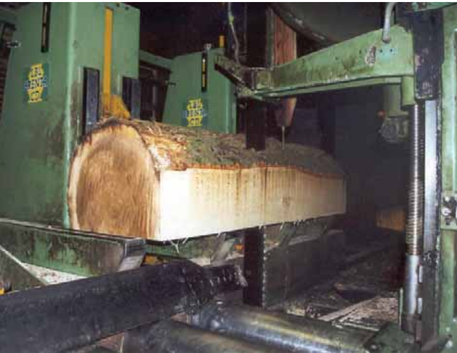
Met bandzagen wordt dik naaldhout en loofhout verwerkt
