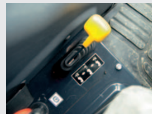
De voorkeuzehendel voor het aftakstoerental vind je voor de parkeerrem en biedt de keuze tussen 540 en 750 omwentelingen.
