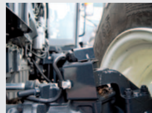
Voor het automatisch in- en uitschakelen van de vierwielaandrijving is een sensor nodig die de hoek van de voorwielen meet.
