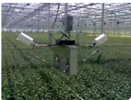
▲ Met een verblazer kan het uitzetten van roofmijten geautomatiseerd worden waardoor biologische bestrijding minder tijdrovend wordt.
