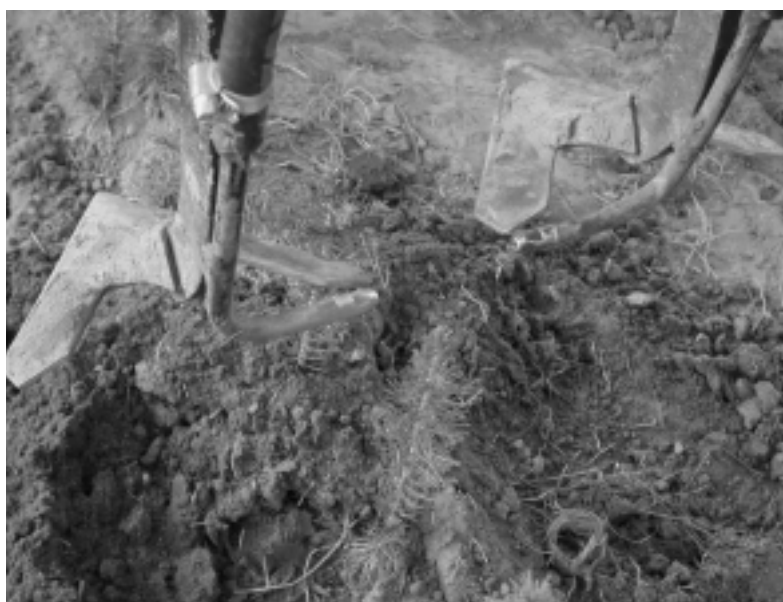
Figuur 3. Pneumat breekt de grond open met schoffels en blaast de onkruiden uit de gewasrij.
