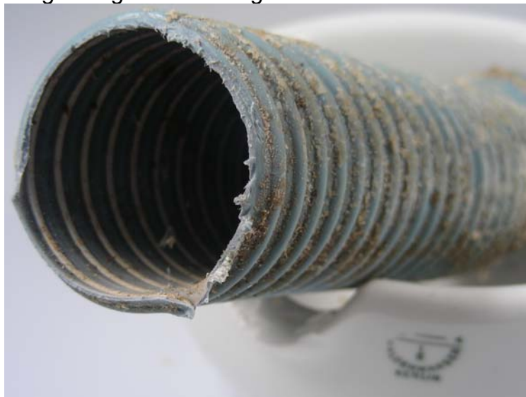
Figuur 10: Foto van doorsnede van drainafvoer slang zoals gebruikt tussen hangende goot en ondergronds drainafvoer.
