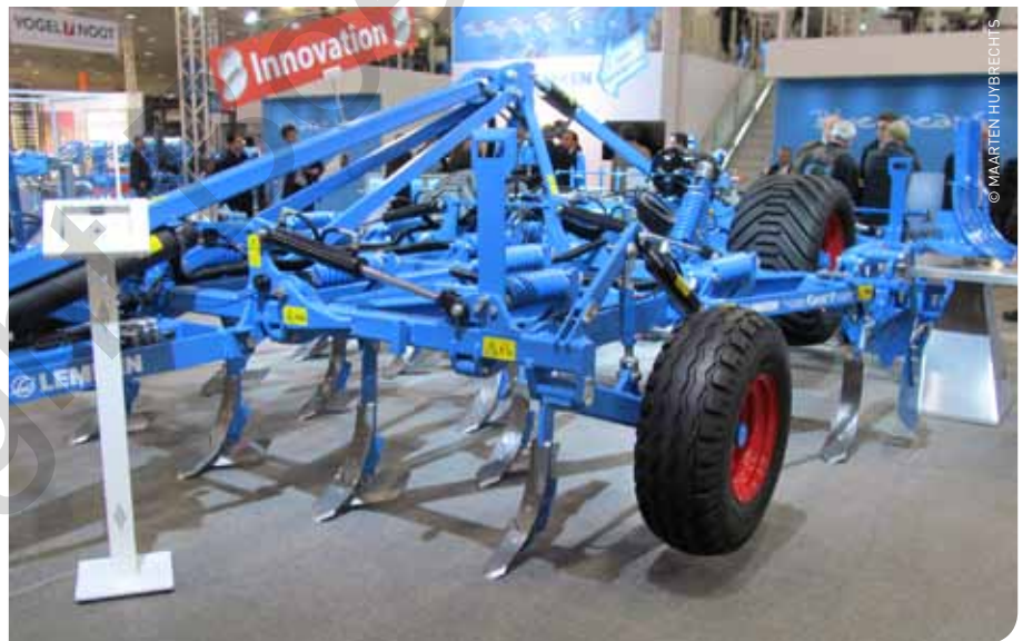
De twee- of driebalksganzenvoetcultivator van Lemken komt nu ook in getrokken uitvoering op de markt. Iets duurder, maar beter voor de wendakker.
