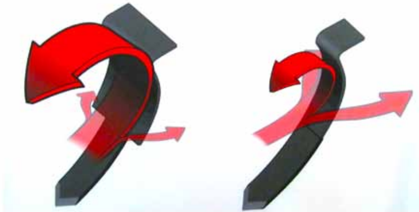
Figuur 2 Detail van de Väderstad TopDown-cultivator met onderwoeler - Bron: Väderstad
