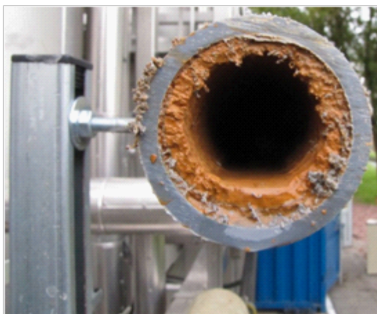
Afbeelding 6. IJzerafzetting in de filtraatleiding van het continue ontijzeringsfilter
