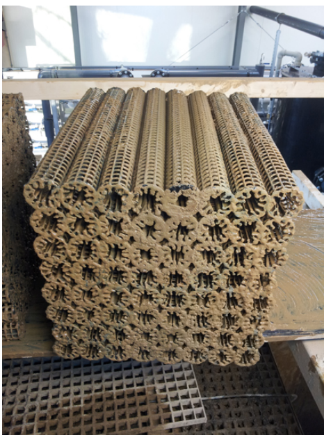
Afbeelding 5. Kalkafzetting op een dragermateriaalblok in de beluchte bioreactor na zes maanden in bedrijf te zijn geweest
