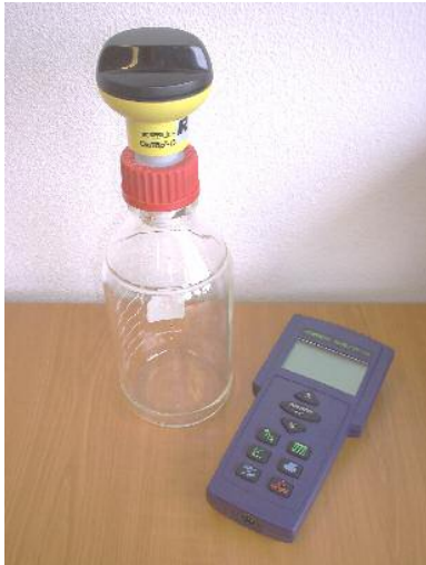
Figuur 2: de Oxitop meetopstelling
