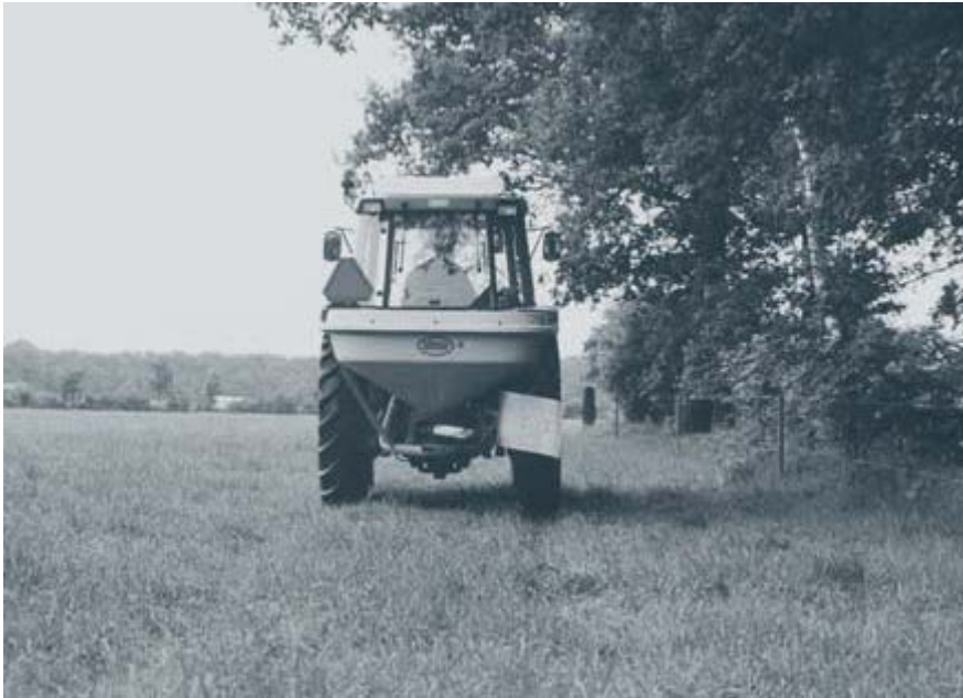
De kantenstrooi-inrichting zorgt ervoor dat er geen kunstmest in de sloot of buiten het perceel terecht komt.
