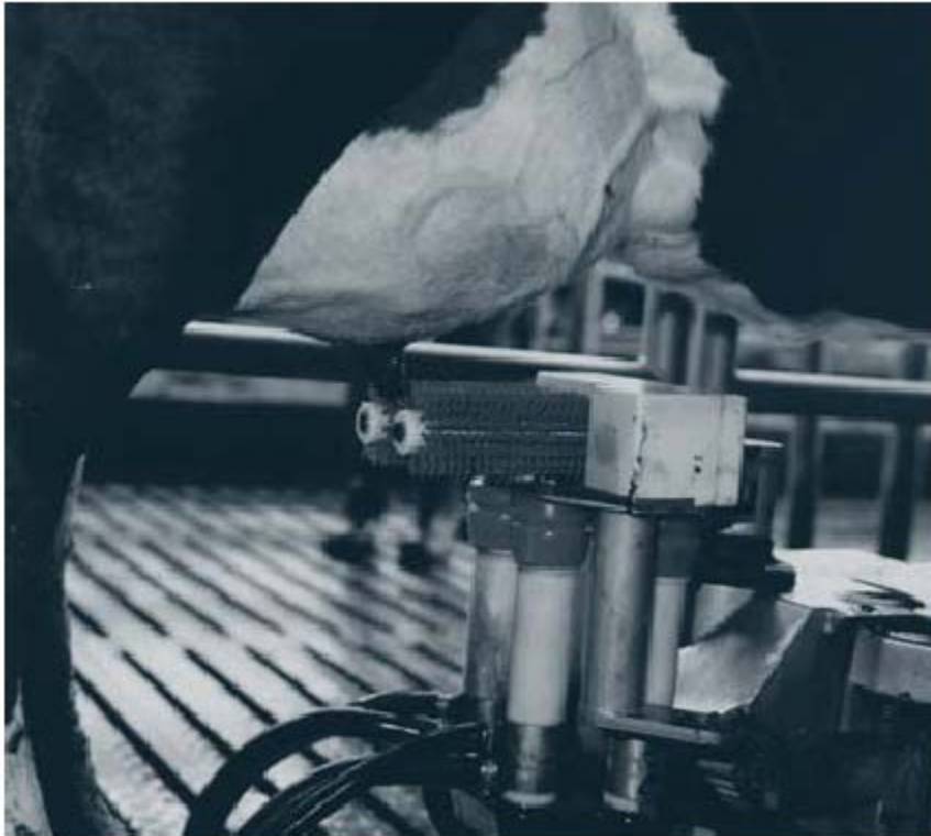
Speenreiniging bij automatisch melken met borstels.
