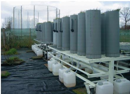
*Fig. 2. Lysimeter opstelling voor het bepalen van de invloed van najaarsbeweiding op het lot van ( $^{15}\text{N}$  gelabelde) urine.*
