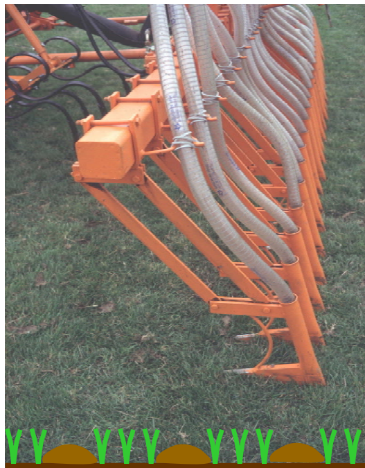
Figuur 2.3. Met een zodenbemester (links) wordt de mest in sleufjes in de grond gebracht. Met een sleepvoetenmachine (rechts) worden strookjes mest op de grond tussen het gras gedoseerd.
