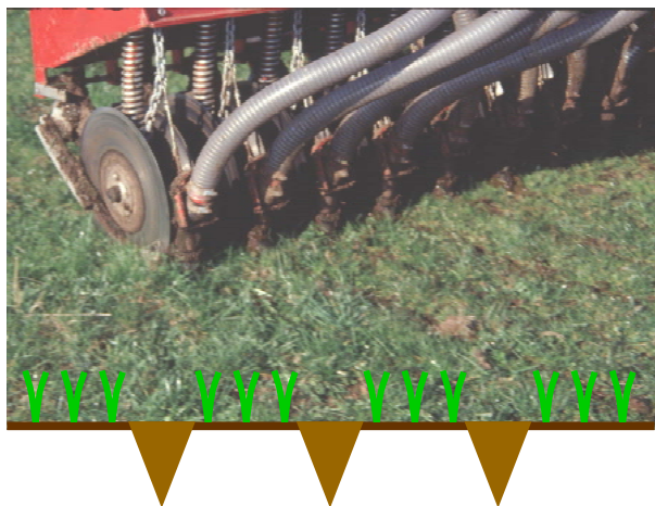
Figuur 2.3. Met een zodenbemester (links) wordt de mest in sleufjes in de grond gebracht. Met een sleepvoetenmachine (rechts) worden strookjes mest op de grond tussen het gras gedoseerd.
