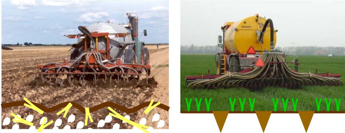
Figuur 2.4. Mest injecteren op niet-beteeld bouwland met een aan de mestmachine gekoppeld werktuig (links). Met een zodenbemester toedienen van mest op beteeld bouwland (rechts); de mest wordt in sleufjes in de grond gebracht.
