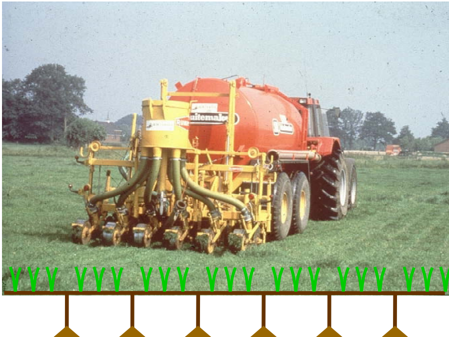
Figuur 2.2. Injecteren van mest waarbij de mest op een diepte van 15-20 cm-mv in sleufjes met een onderlinge afstand van 50 cm wordt gedoseerd. De sleufjes worden met een rol dichtgedrukt.
