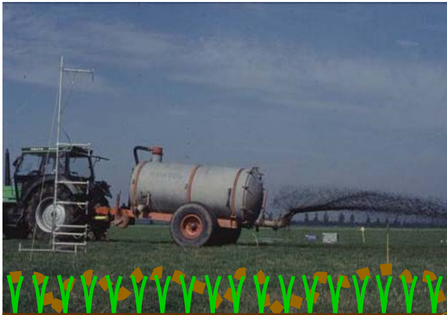
Figuur 2.1. Bovengronds breedwerpig toedienen van mest (BMT) en de verdeling van de mest op het gras.
