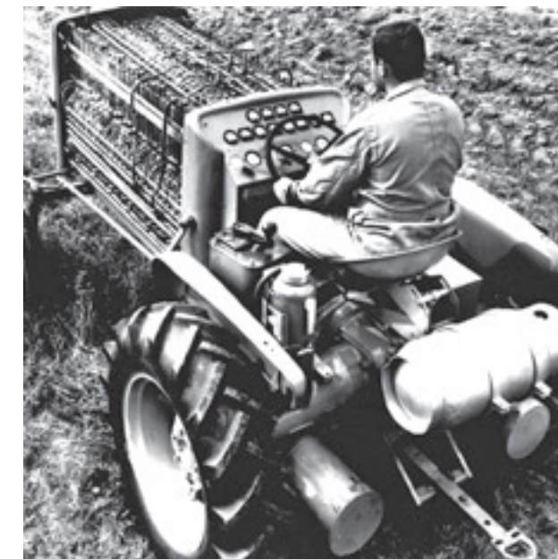
▲ De allereerste trekker met een brandstofcel. Allis Chalmers bouwde in 1959 een D12.
