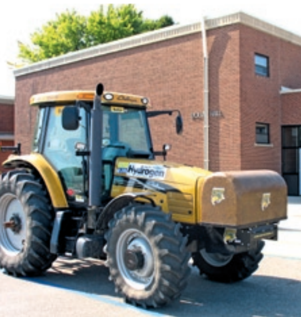
▲ De H2NDSU van de universiteit van North Dakota loopt op een mengsel van diesel en waterstof.
