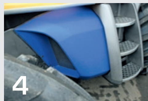
▲ Om de elektromotoren te koelen, zijn er twee extra koelers gemonteerd.
