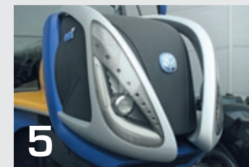
▲ De led-voorlampen van de NH2 staan los van de grille. Dat levert een groter koeloppervlak op.
