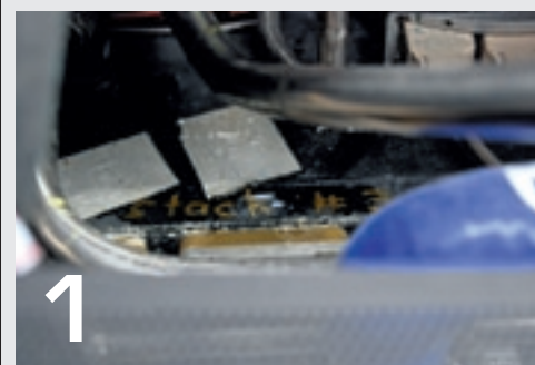
▲ Het hart van de NH2: de brandstofcel. Er liggen drie 'stacks' onder de tank.
