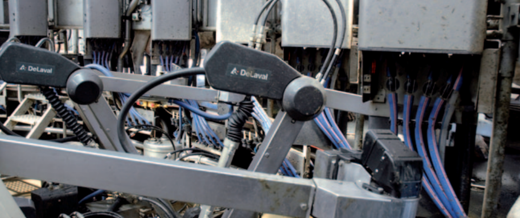
^ Vijf robotarmen doen in de AMR het werk. Een reinigt de voorspenen, de ander de achterspenen. Twee armen sluiten elk twee tepelbekers aan en de vijfde arm behandelt na. De draaimelkstel is een 24-stands visgraat die relatief weinig ruimte vraagt en waar de melkklaauw van de zijkant is aan te sluiten.
