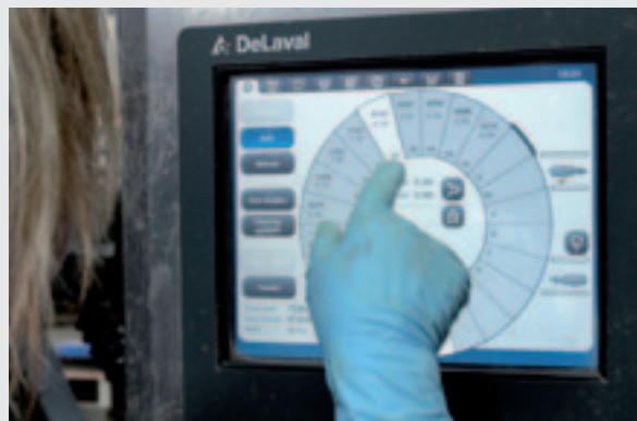
^ Het touchscreen geeft de melkgift weer van elk van de 24 koeien. Door een koe aan te tikken geeft het scherm weer hoe de melkgift verdeeld is over de kwartieren. De gift per koe blijft zichtbaar op het scherm.
