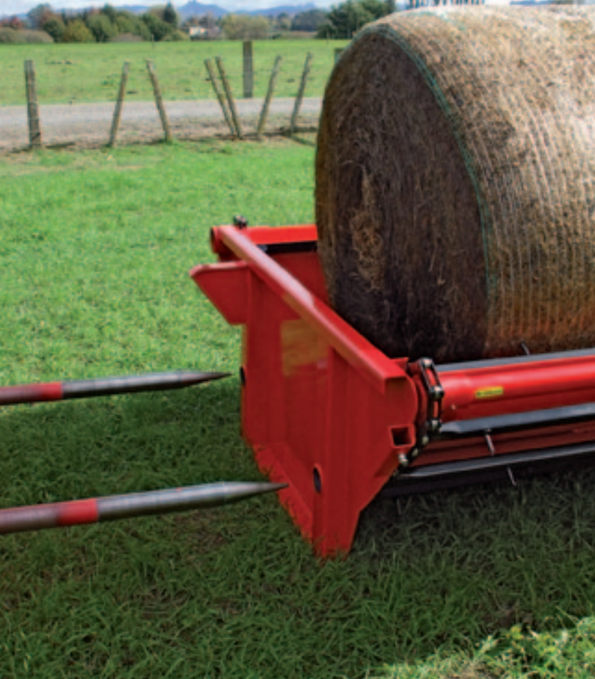
De semi-zelfladende ontrollers bestaan uit twee delen. De balenvork fungeert als een soort palletvork die de ontroller draagt.
