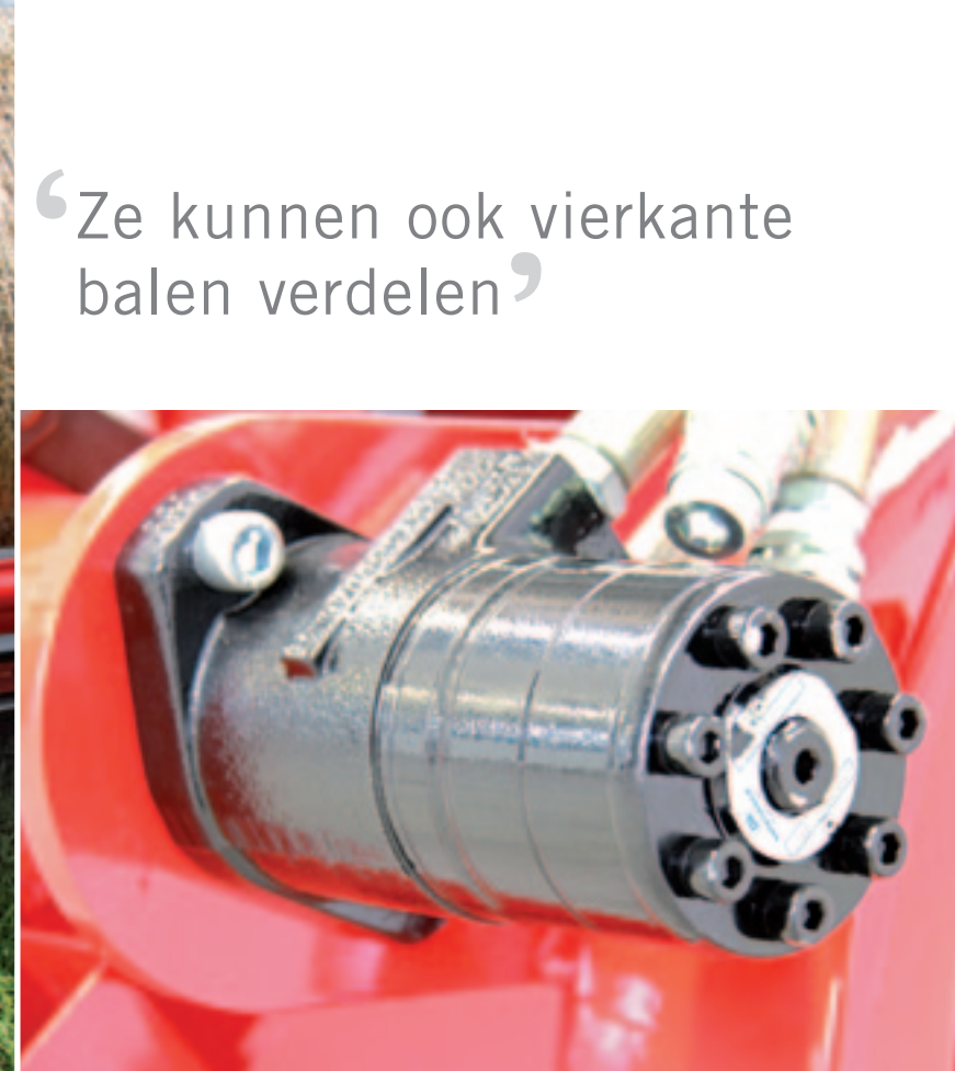
De hydromotor die de ontroller in beweging zet, zit op de balenvork. Via een soort mof koppelt hij bij aanpikken met de kettingaandrijving van de ontroller.
