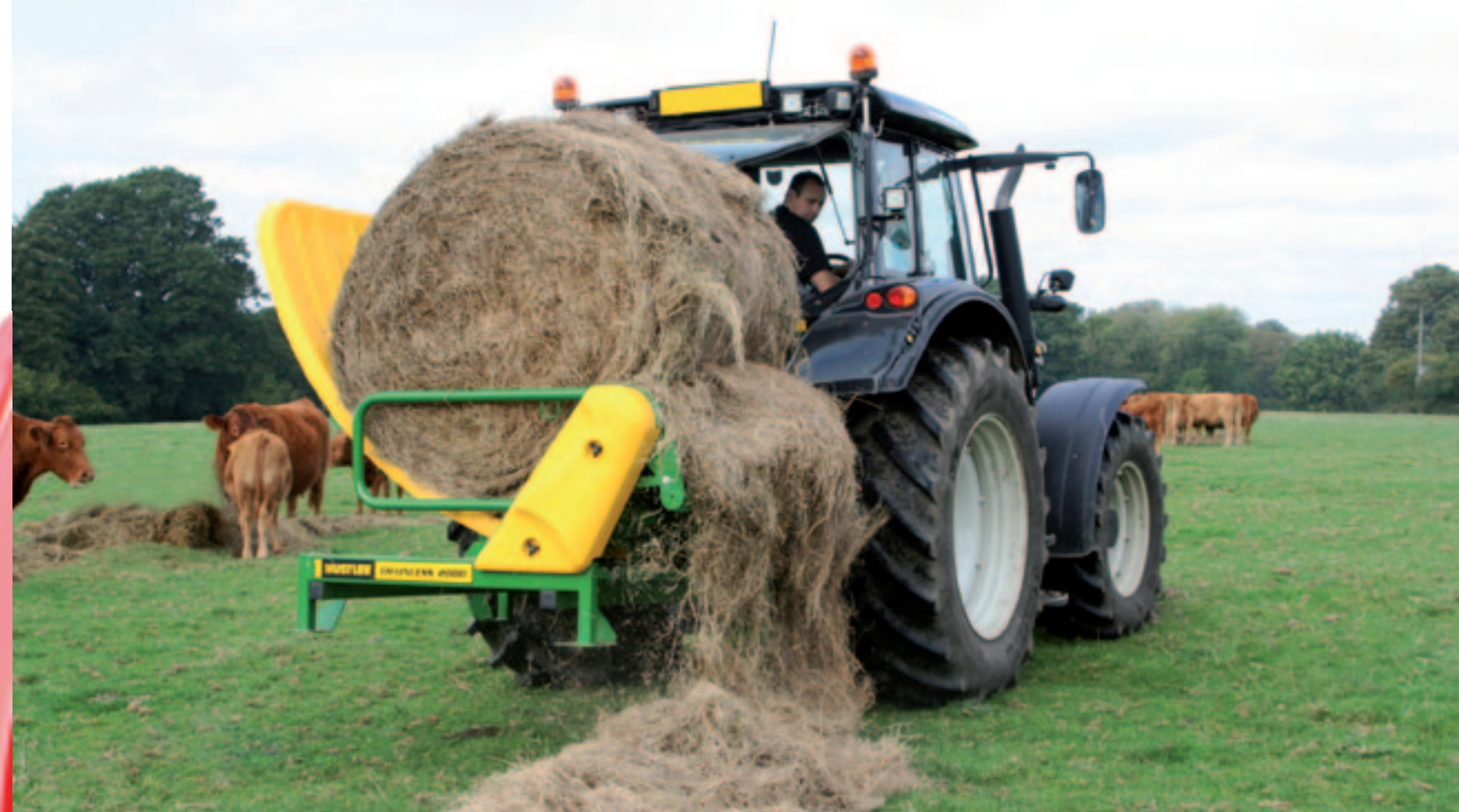
Het Nieuw-Zeelandse Hustler levert ook de 'Chainless' zonder kettingaandrijving om de baal te ontrollen. De ketting zou het meest slijtagegevoelige onderdeel zijn. Twee getande rollen en een bewegende kunststof bodemplaat doen bij deze machine het werk. De kettingloze ontrollers kunnen ook vierkante balen verdelen.
