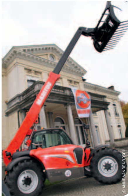
Het MLT-segment van 6 en 7 m, waaronder deze MLT 735, kreeg een nieuwe Deutz-motor die voldoet aan de Stage 3B-Tier 4 Interim-emissie-normen.
