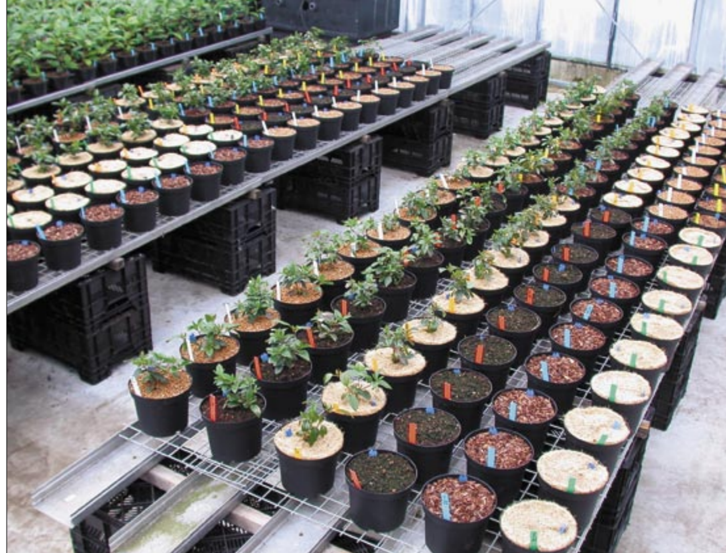
Een deel van de proefopstelling met afdekmaterialen voor verdampingsmetingen bij Viburnum tinus .
