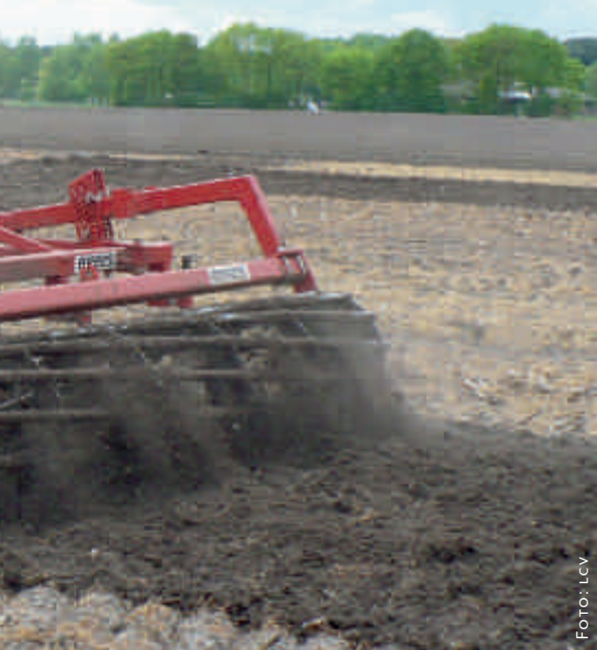
Niet-kerende grondbewerking met een vleugelschaarcultivator.
