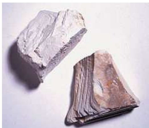
Kaolinit kleimineralen, zoals gewonnen uit de mijn en kaolinit \text{Al}_2\text{O}_3 \cdot 2\text{SiO}_2 \cdot 2\text{H}_2\text{O} molecuulstructuur (bron: Wikipedia)
