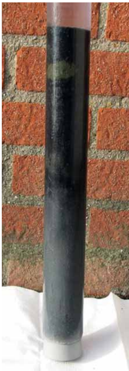
Extrem zwartkleuring van het zand en slib (dikte circa 20 cm) wijzen op de aanwezigheid van ijzersulfiden in de bodem en de rol van sulfaat in het systeem (diameter van de steekbuis bedraagt 4,5 cm).
