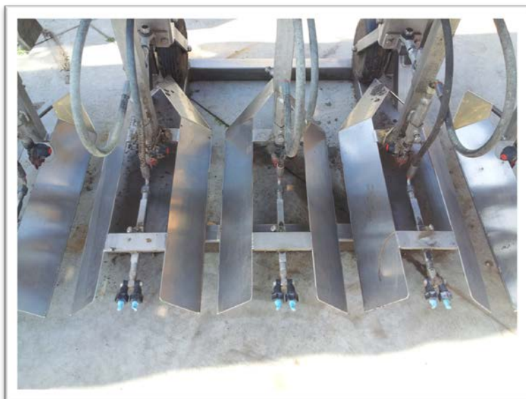
Figuur 3. Spuitboom met een opwaarts gericht spuitbeeld, voor de bestrijding van Cylindrocladium in Buxusbollen.
