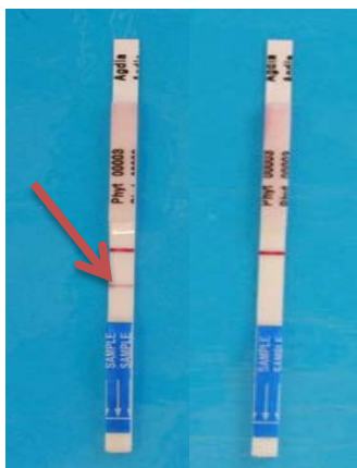
Figuur 19. Phytophthora-immunostrips van Agdia waarmee de aanwezigheid van Phytophthora in plantmateriaal eenvoudig is vast te stellen. De pijl wijst naar een streepje dat verschijnt bij een positieve uitslag, er was dus Phytophthora aanwezig.
