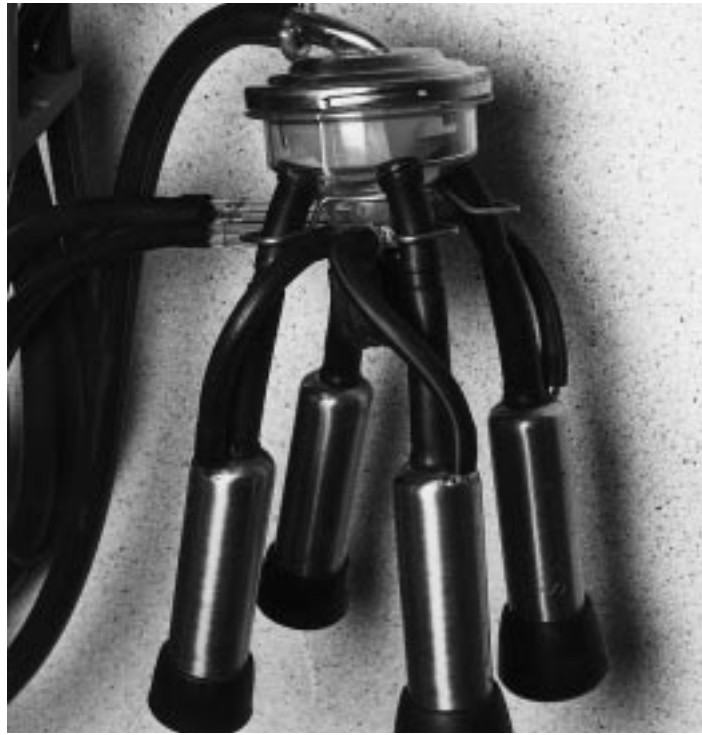
Melkklauwconstructie met gescheiden afvoer van melk en lucht (Triovac).
