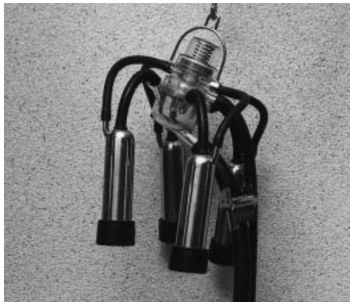
Constructie waarbij klauw en drukwisselaar één geheel vormen (Nu-Pulse).
