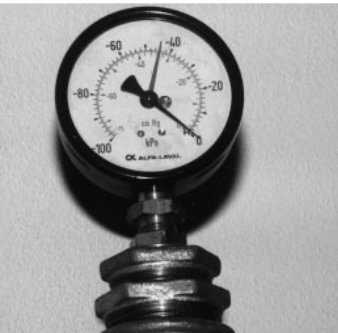
Wijzervacuümmeter met schaalverdeling in kPa.
