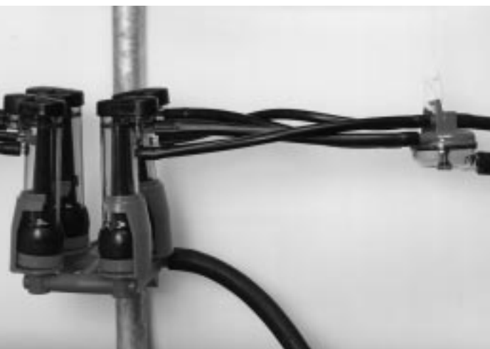
Een geitenmelkstel met zelfsluitende tepelbekers.
