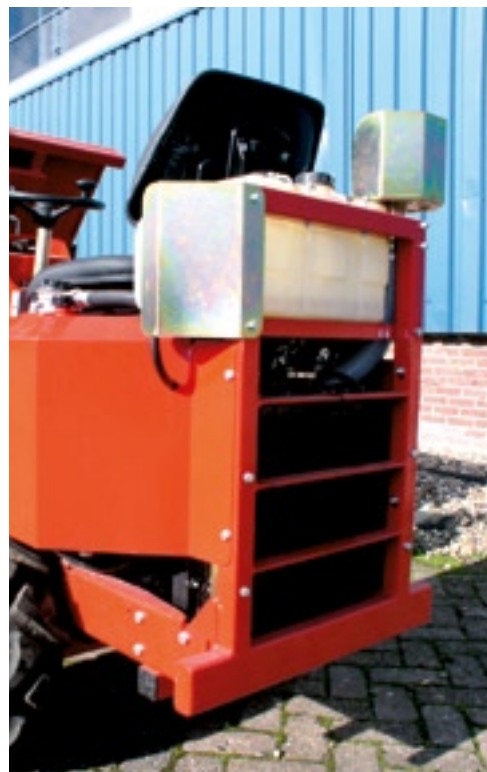
Op de nieuwste machine zijn extra beschermkapjes gemonteerd. Bescherming van de radiator vraagt om verbetering.
