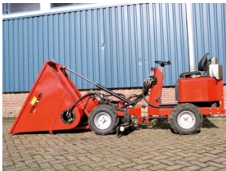
De Trixon N4500 kan zichzelf laden. Dan moet je de bezem uitklappen.
