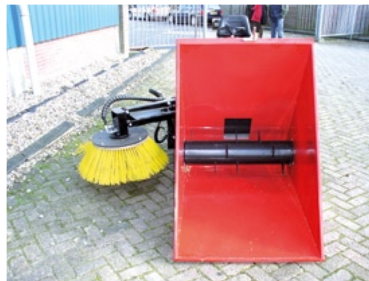
Een frees in de bak brengt het zaagsel op het schoepenrad. De doorgang is middels een draaihendel in grootte te variëren.
