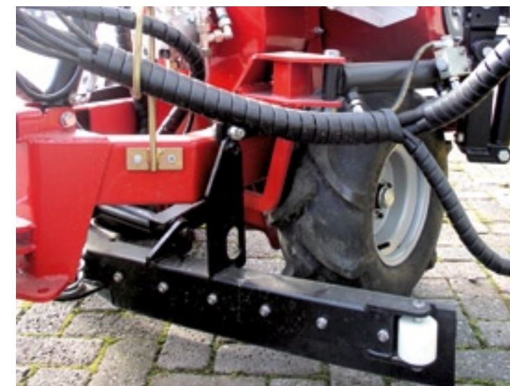
Door de verstelbare uiteinden van het blaaskanaal kan het stroobereik aangepast worden. De mestschuif heeft een geleidewielletje zodat je strak langs de ligboxen kunt rijden.
