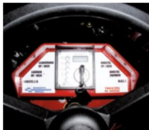
Starten is de enigste elektrische handeling. Met zes hydrauliekhendels worden alle functies bediend. Een brandstofmeter ontbreekt op de display.
