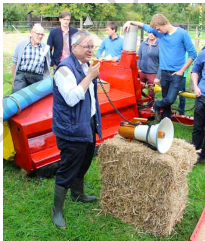
Dirk Remue gebruikt deze omgebouwde getrokken hakselaar om de gemaaide miscanthus op te rapen en te verhakselen. Dankzij de blauwe flexibele buis wordt verstopping grotendeels vermeden.
