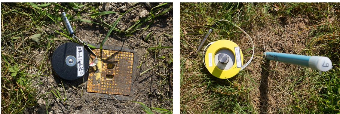
Afbeelding 1. Meetlint met akoestisch dompelklokje (links) en elektronisch peilapparaat met geluidssignaal (rechts)
