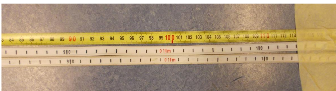
Afbeelding 4. Het bovenste meetlint is bevestigd aan een dompelklokje, de onderste twee meetlinten aan elektronische peilapparaten met geluidssignaal.
