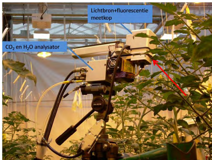
Figuur 8. Licor-6400 draagbare fotosynthesemeter, gebruikt voor het meten van de \text{CO}_2 opname (fotosynthese) door Plant Dynamics B.V.
