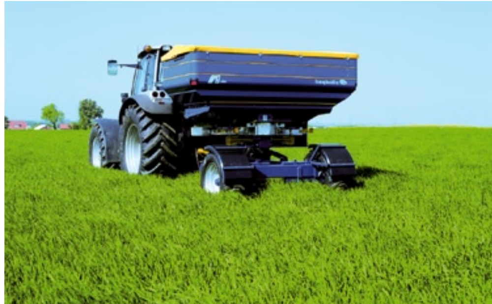
Met een getrokken strooier combineer je een grote kuipinhoud met minder bodemdruk.
