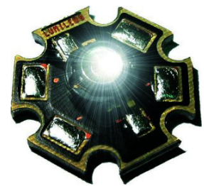
Figuur 3.12 Het lichtrendement is gedefinieerd als de lichtstroom per Watt elektrische energie (lumen/W e )
