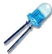
Figuur 3.7 De blauwe LED is de basis voor witte LEDs
