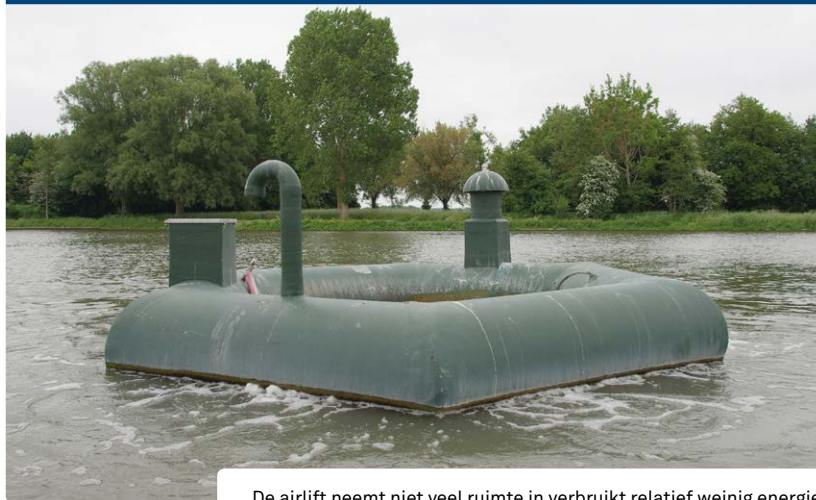
De airlift neemt niet veel ruimte in verbruikt relatief weinig energie.
