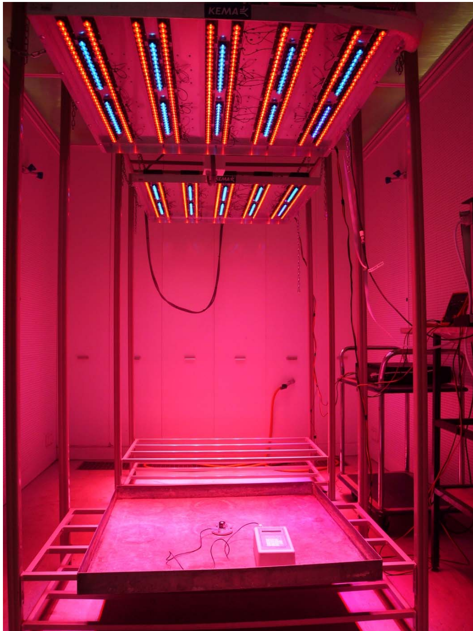
Figuur 2.9 Foto van proefopstelling in de klimaatcel. Op de voorgrond ziet u een kweekbak met daarin in een PAR-lichtmeter. De twee opstellingen (eerste pulserend, de tweede continu) waren tijdens de experimenten gescheiden door wit plastic. De armaturen bevonden zich op ongeveer 1.8 m boven de kweekbak
