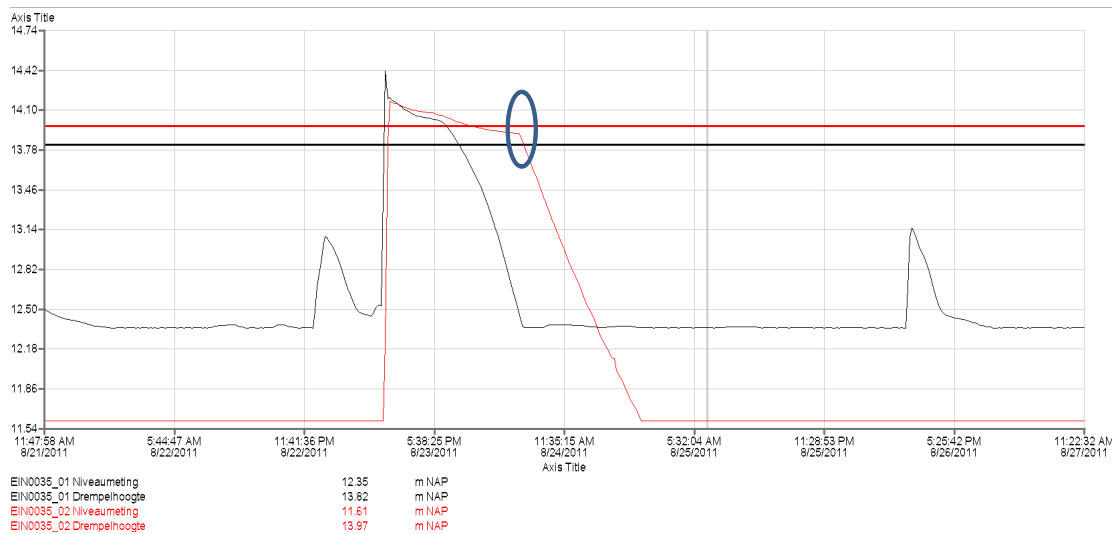
Figuur 2. Gemeten waterstanden (m NAP) in de tijd in twee overstortputten
