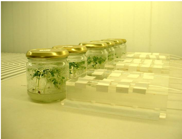
Figuur 3: Meetopstelling waarbij het metabolisme van weefselkweekplantjes automatisch en niet-invasief wordt gemeten.
