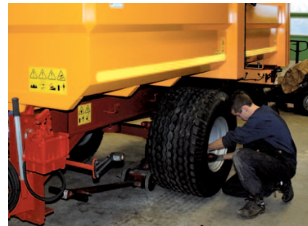
De kiepwagen heeft een hydraulisch bediende reminrichting.
