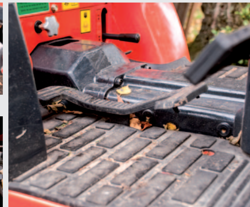
Met je rechervoet bedien je het rijrichtingspedaal: trap met de bal van je voet op het pedaal en gaat vooruit. Om achteruit te rijden trap je met je hak op hetzelfde pedaal.
