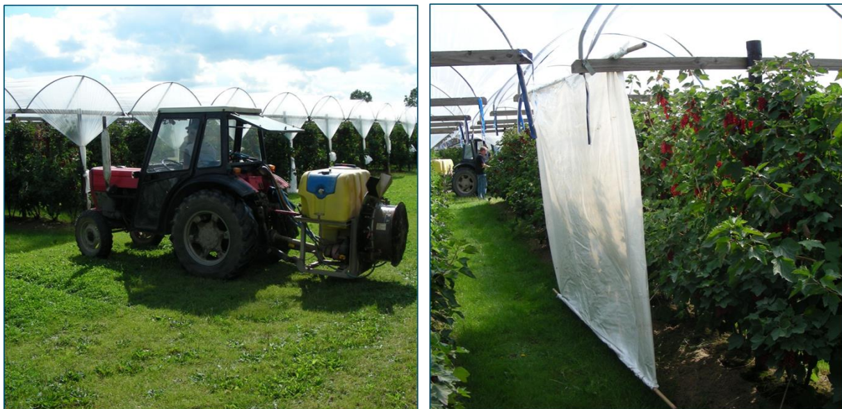
Figuur 2a, b: axiaalspuit voor uitvoering van de proefbespuitingen, en schermen tijdens uitvoering van een bespuiting.
