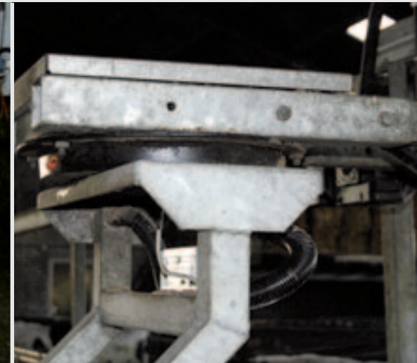
Met behulp van de draaikrans kan de machine zich langs het voerhek opklappen. Ook voorkomt het grote krachten op de rail.
