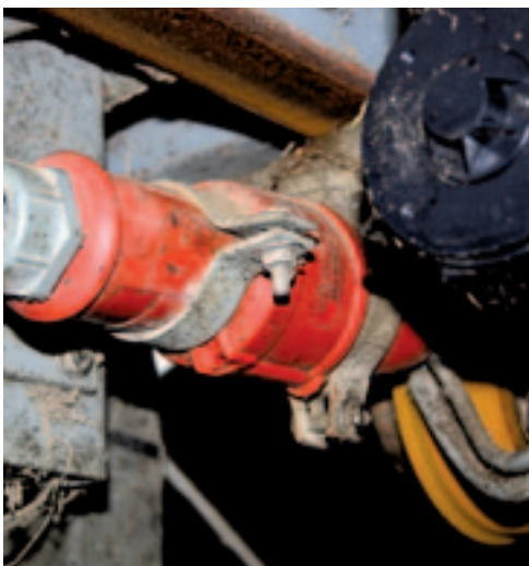
Aan het eind van elke ronde wordt de Butler opgeladen door simpelweg in een krachtstroomstekker te rijden.
