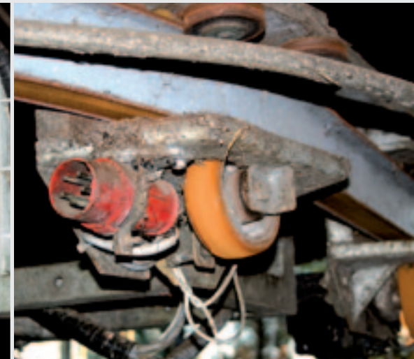
De robot volgt een rail die langs het voerhek gemonteerd is.
