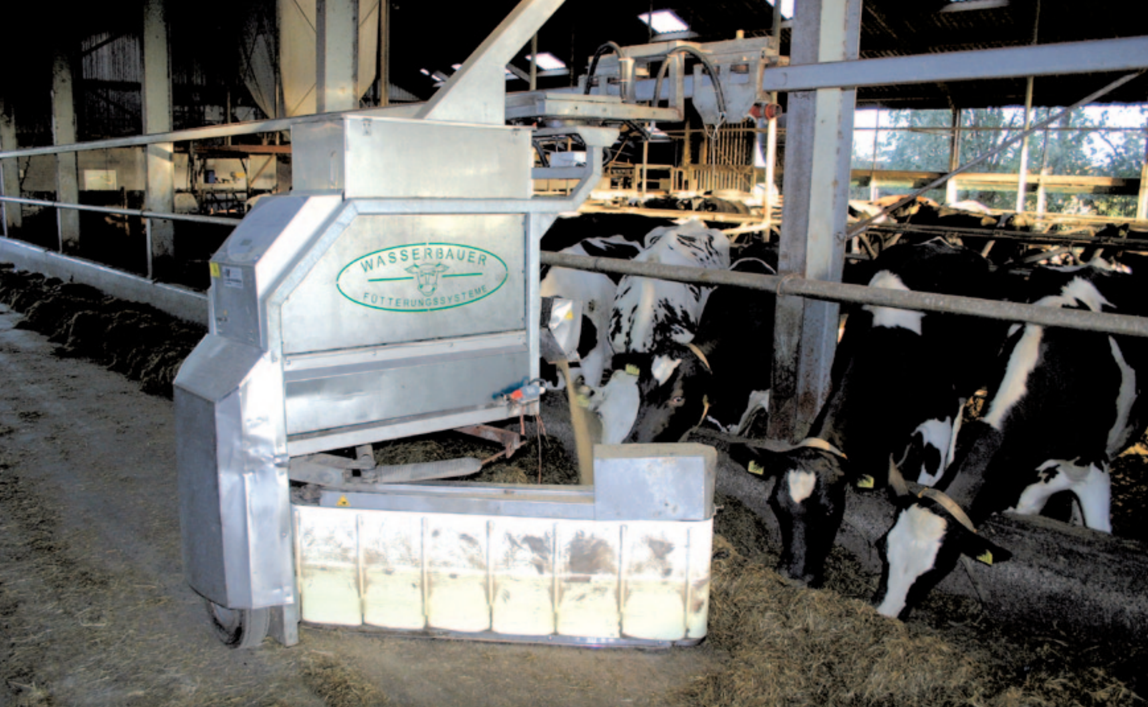
De transportband draait het voer naar het voerhek. De veer regelt de duwdruk.
