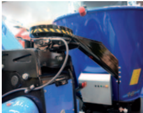
Met een zwanenhals is de Peecon Biga Volt aan een verreiker te koppelen.
