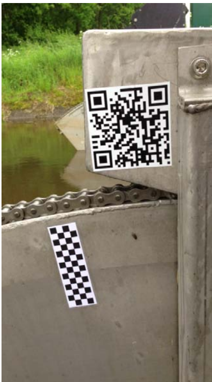
Afbeelding 3. Mobiel Water Meten van een stuwstand (links originele foto, rechts verwerkte foto met perspectiefcorrectie en bepaling hoek stuwstand)
