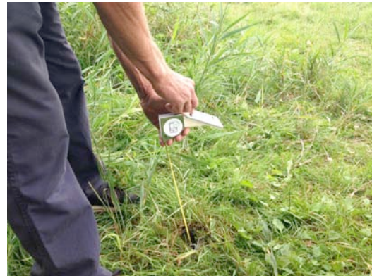
Afbeelding 2. Mobiel Water Meten van een grondwaterstand
