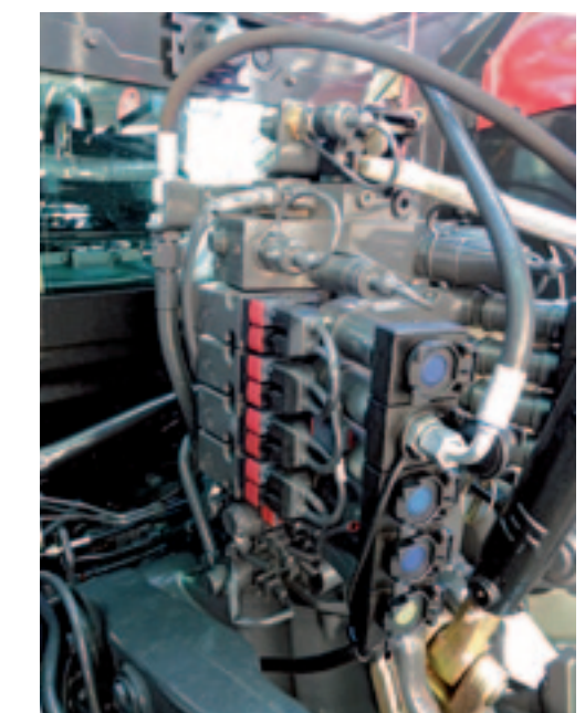
▲ Het ventielenblok achter op de trekker met de elektrische aansturing.
