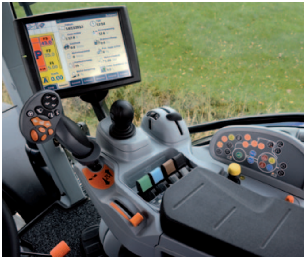
▲ Met de joystick stuur je zowel de transmissie, de hef als een hydrauliekcilinder aan. Het aanraakscherm geeft alle informatie in kleur weer. Flippers en een joystick bedienen de hydraulische ventielen.
