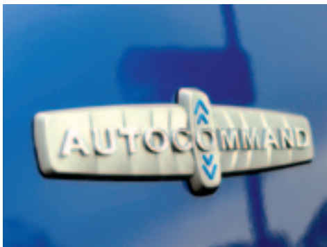
▲ Alleen dit AutoCommand schild verklaart dat de trekker een traploze transmissie heeft.
