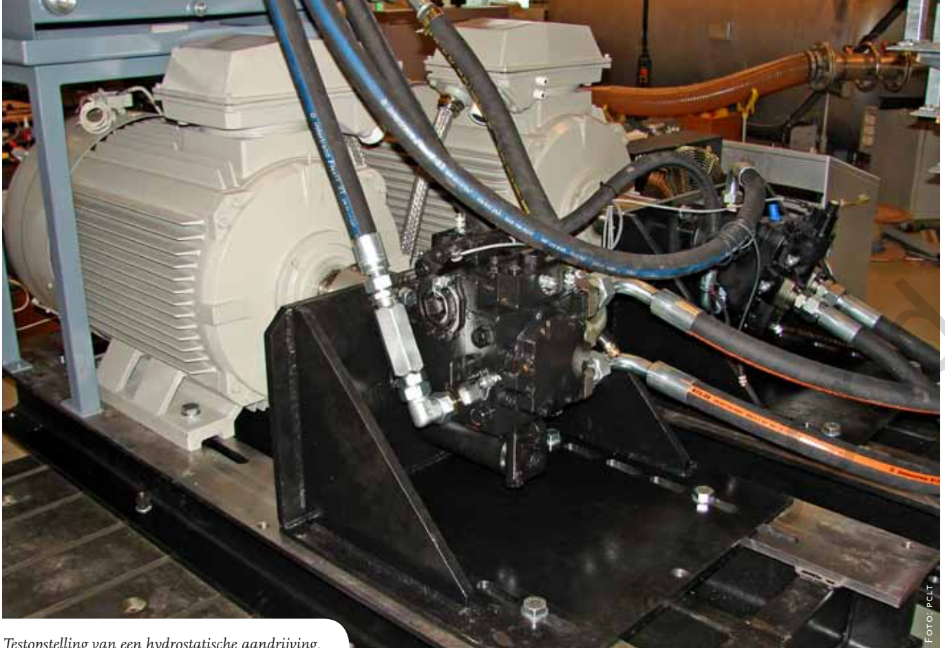
Testopstelling van een hydrostatische aandrijving.
