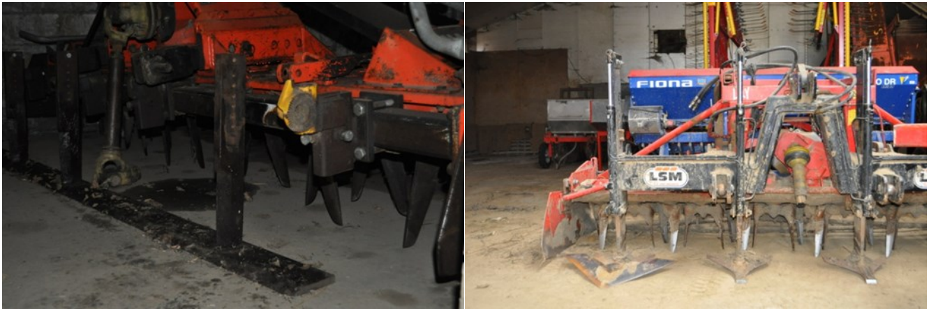
Figuur 1: Volvelds mes of brede ganzevoeten in combinatie met rotoereg om groenbemester te vernietigen
