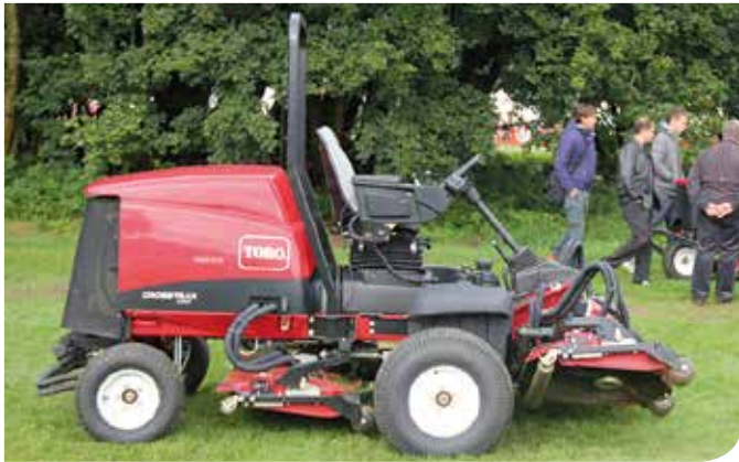
De 'Toro Groundsmaster Smart Power Control' past de snelheid automatisch aan naargelang de maaiomstandigheden.
