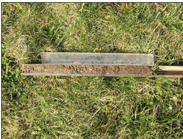
Foto 2: Bepalen van de doorworteling met behulp van een gutsboor.
