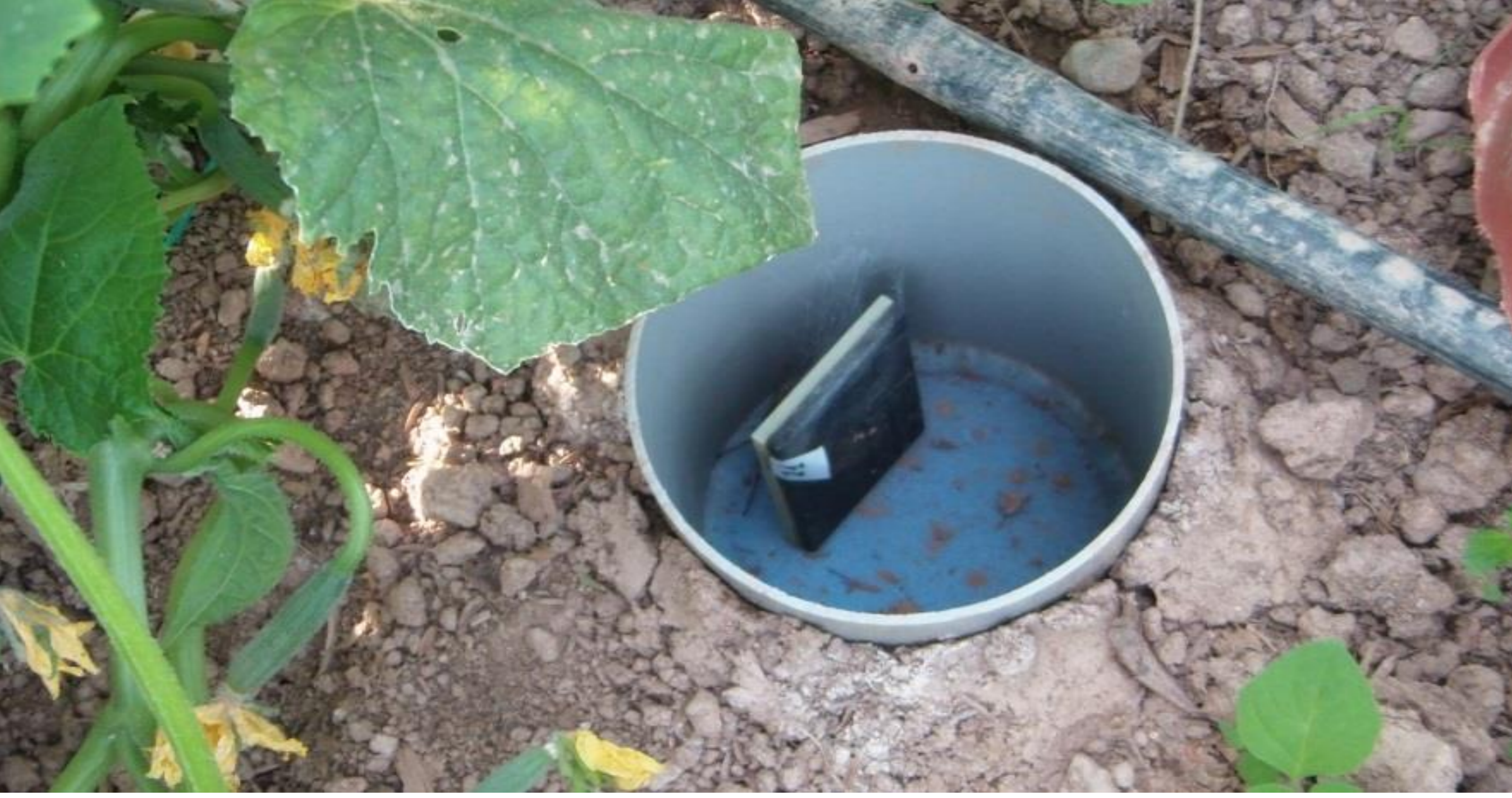
Şekil 2. Hıyar üretiminde PVC kılıf ile yerleştirilmiş AquaTag sensörü.
