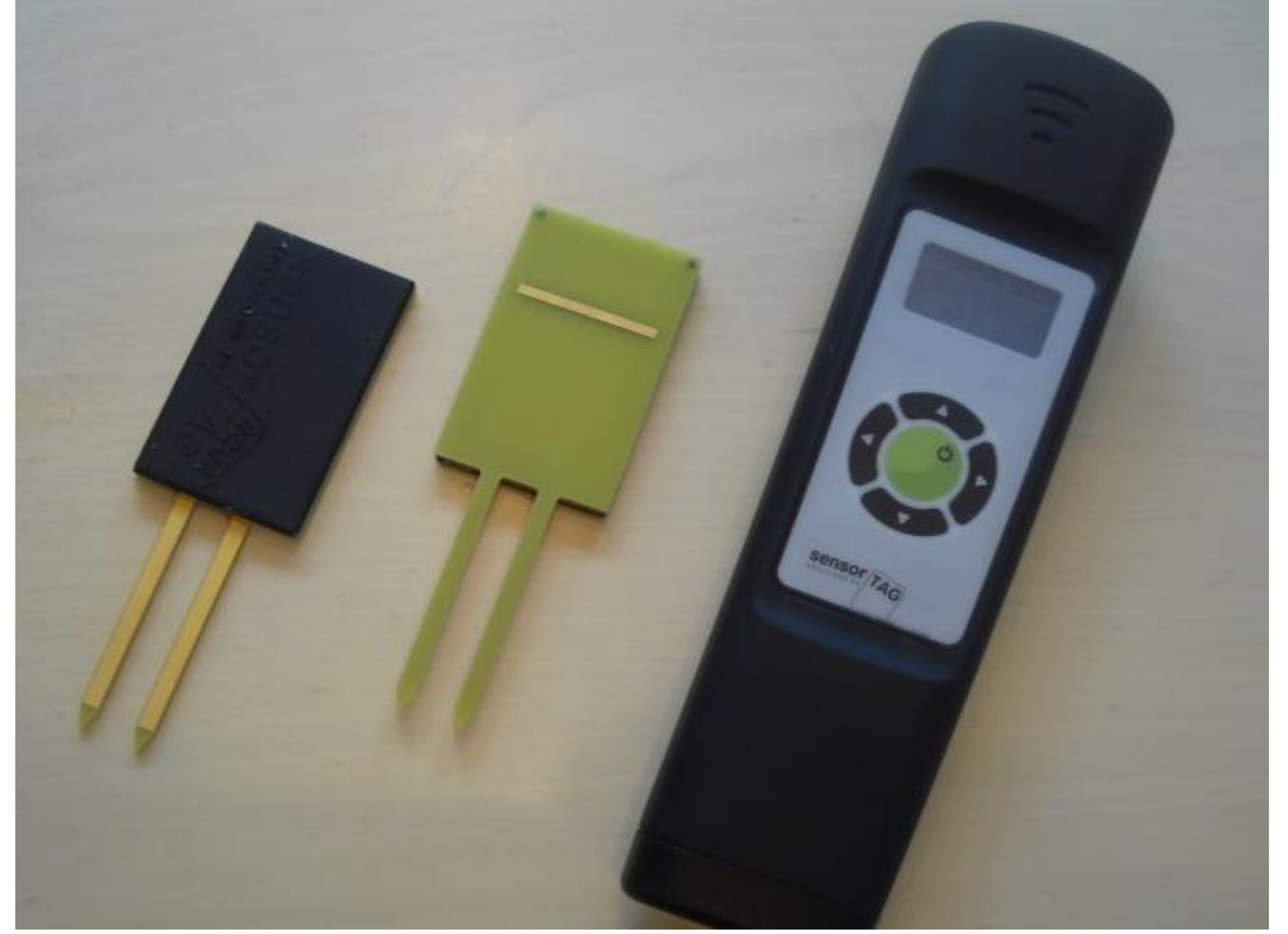
Şekil 1. AquaTag (solda) sensör ve okuyucusu (sağda).
