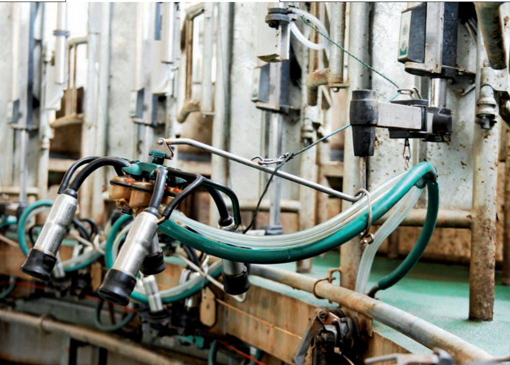
De melkstellen zijn bevestigd aan een beweegbare arm die als 'tilhulp' fungeert
