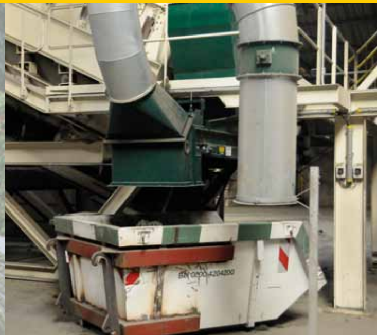
Windzeven: tijdens dit proces worden de geshredderde matresten door een luchtbuis naar een volgende hal gezogen. Tijdens deze reis vallen de zwaardere backingresten naar beneden in een container. Alleen de vezels gaan door.
