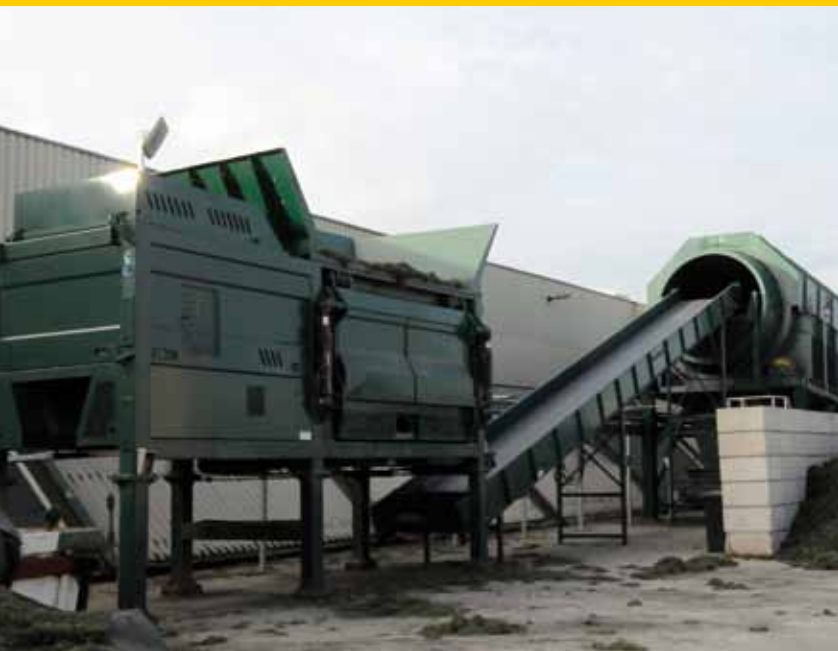
Er is op dat moment te zien hoe het proces verder gaat vanaf acceptatie op het recyclecentrum: een kunstgras voetbalmaat wordt zojuist door de shredder verwerkt. Daarna wordt het geshredderde materiaal voor de eerste maal gezeefd om het zand, rubber of gravel te scheiden van de kunststof matresten. De infill wordt verder gezeefd om weer schoon materiaal te worden. De matresten krijgen een nabewerking om de infill er nog beter uit te halen en om de vezel voor te bereiden voor de hoogwaardige opwerking voor nieuwe producten.
