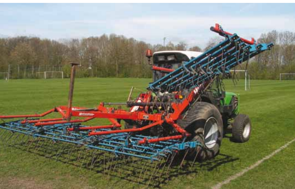
Henrie Bekkers: 'Een van mijn favoriete machines is de wiedege. Wiedeggen zorgt voor een beter water en luchthuishouding. Mede door de snelle werkzaamheid kan het bijna altijd uitgevoerd worden.'
